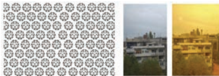
Slika 6.33. Tanak film od molekula C_{60} debljine 60–100 nm, na staklenoj podlozi. Raspored molekula C_{60} u filmu. Zbog \pi elektrona koje ima svaki C_{60} molekul stvaraju se odbojne sile i molekul slobodno rotira oko 3 \times 10^{10} s^{-1} (Koruga, Dj. PCT Patent US2008/0286453 A1, Aplikant DVB Global USA).
