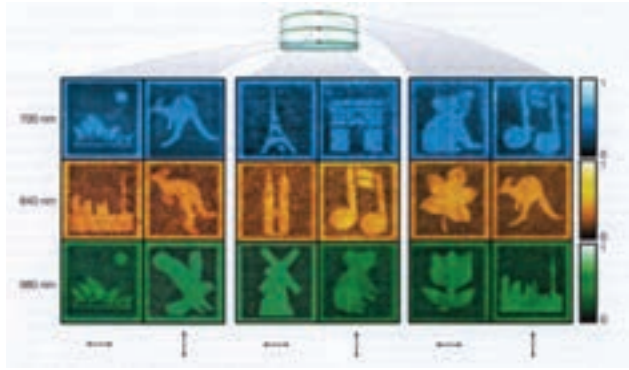
Slika 2.7. Prva petodimenzionalna memorija na bazi tri talasne dužine i dve polarizacije svetlosti u realizaciji memorije od 1 Tbit/cm 3 (Zijlstra et al, 2009).
