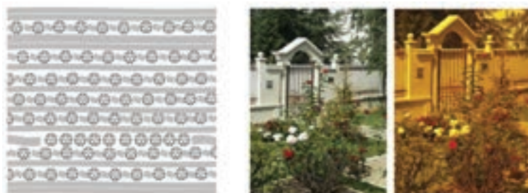
Slika 6.34. Jedna od mogućih varijanti organizacije C_{60} u polimerni materijal PMMA, HEMA i dr. (levo). Ambijent slikan aparatom bez nanofotonskog filtera i sa njim. Maksimalni pik hiperpolarizovane svetlosti, čiji su se fotoni reorganizovali, iznosi 728 nm. Da bi se to ostvarilo debljina filtera treba da bude oko 20 mm. Drugi deo svetlosti kod koje je nastupila energetska transformacija je u domenu daleke infracrvene svetlosti (Koruga, Dj., Int. Pat. App. PCT/EP2016/063174, 2016, aplikant Fieldpoint, Cipar/ ZEPTER GROUP).
